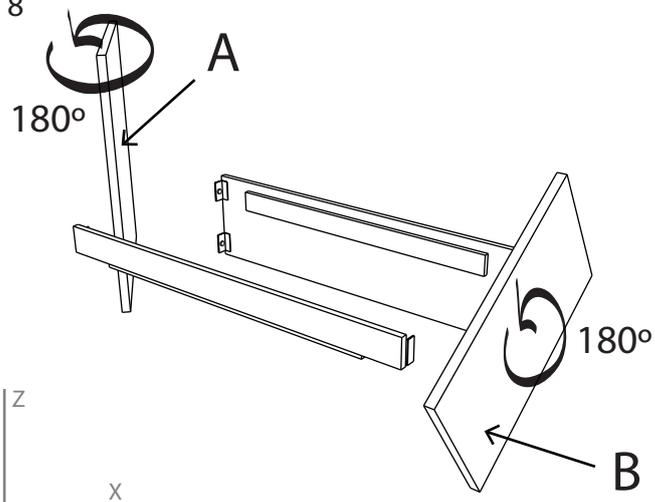
Girar el cabezal(A) 180° sobre el eje X
