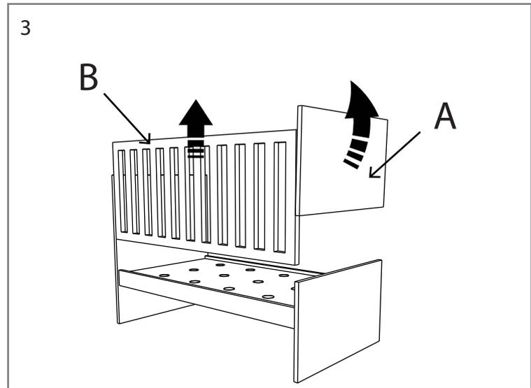
Sujetar la barandilla (B) móvil para evitar que caiga y retirar la parte superior del picero (A)
