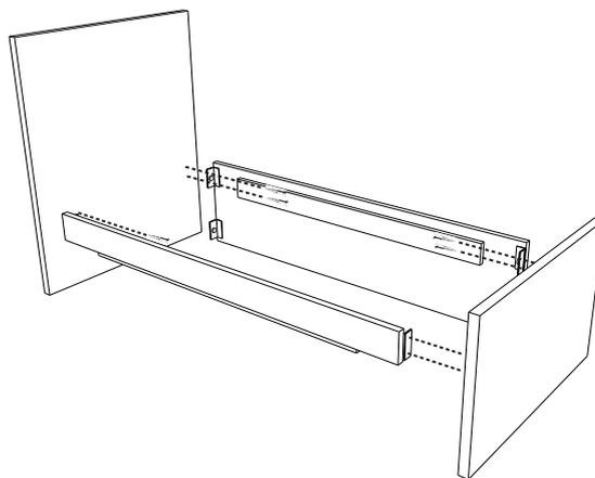
Desatornillar el cabezal y el piecero de las bancadas
