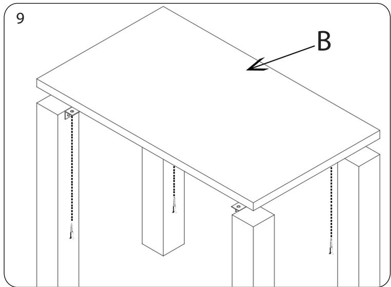
Unir el sobre con las 4 patas mediante escuadras, atornillar usando tornillos de métrico 4. Comprovar que quede bien centrado.
