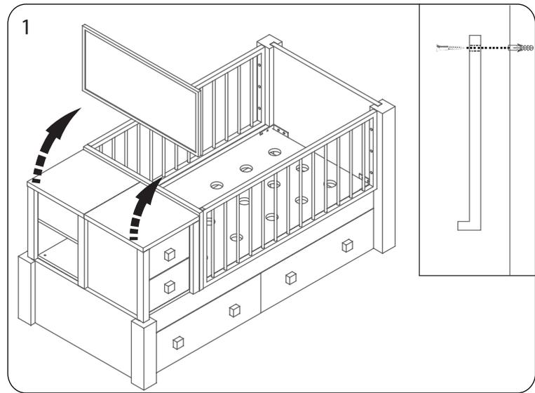
Levantando la pizarra situada encima de las mesitas y atornillando a la pared con tornillo y taco métrico 4.
