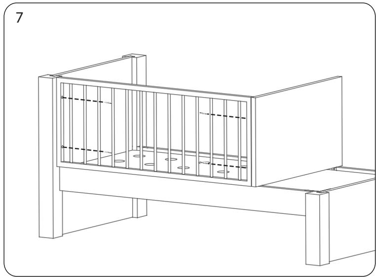
Desatornillar barandilla fija. Para usar de estantería repetir la misma operación seguida en el caso de la barandilla móvil.
