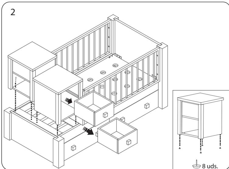
Retirar los cajones de la mesita (inclinarlos a 35° aprox. para su cómoda extracción) y desatornillar las dos mesitas del mueble. Colocar los 8 tacos para evitar rallar los suelos (4 en cada mesita).
