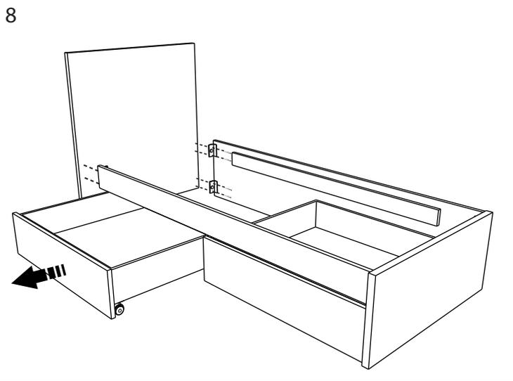
Desatornillar el cabezal de las bancadas. Para ello deberemos retirar el cajón inferior o nido
