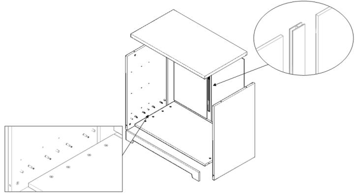
Unir y atornillar los laterales, base, sobre, zocalo y traseras mediante excéntricas, clavias y la guía de plástico.
