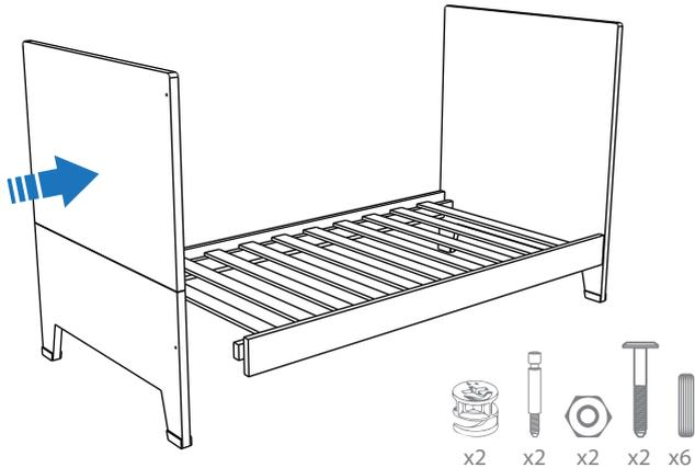
Repetir la misma operación que en las viñetas 1 y 2 para unir el cabezal B al conjunto. Se recomienda no atornillar totalmente para facilitar el proceso de la viñeta 4.
