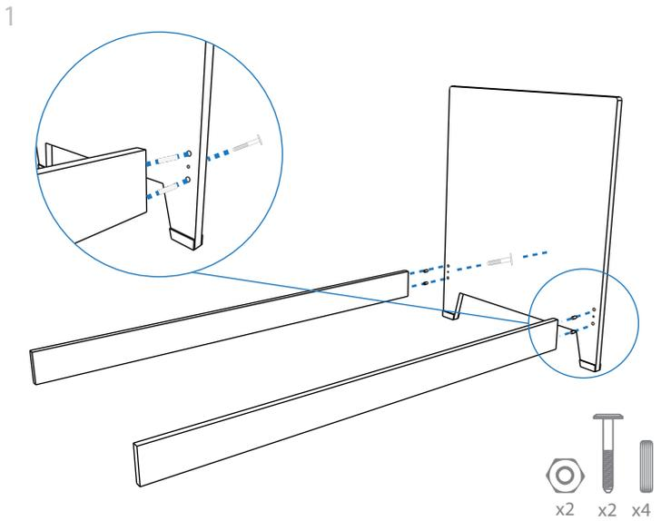
Unir el cabezal A a las bancadas D introduciendo en primer lugar las clavijas en los orificios del cabezal, en segundo lugar las tuercas en los orificios de las bancadas y finalmente atornillar mediante los tornillos.
