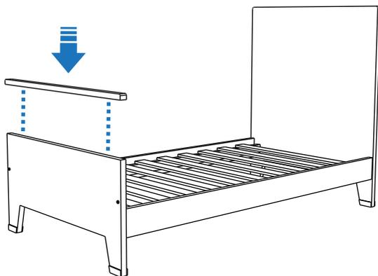
Para convertir la cuna en una camita juvenil, retirar las ruedas presionando hacia fuera, así como las barandillas C y la parte superior del cabezal B, substituyéndola por la pieza F.
