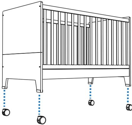
Introducir las ruedas G en el cabezal B y las ruedas H al cabezal A. Para que queden bien fijadas hace falta ejercer una leve presión hasta que entren totalmente en el agujero.
