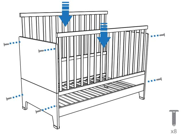
Insertar y atornillar las barandillas C al conjunto. Una vez atornilladas las barandillas, podemos acabar de apretar el cabezal B al conjunto.
