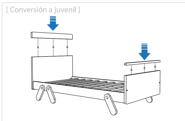
Unir el embellecedor F con el cabezal a.2 y el embellecedor G al piecero b.2 mediante las clavias.
