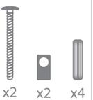
Unir el cabezal A a las bancadas D introduciendo en primer lugar las clavijas en los orificios del cabezal, en segundo lugar las tuercas en los orificios de las bancadas y finalmente atornillar mediante los tornillos.
