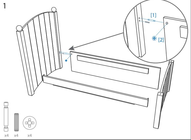
[1] Colocar una clavija en el agujero y enroscar un perno en el cabezal. Unir el cabezal con la bancada a través de los herrajes. [2] Colocar la excéntrica y atornillarla. Repetir ésta operación para unir los 4 costados de la cama.
