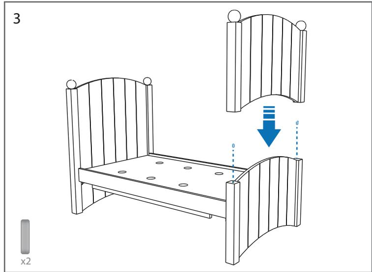
Introducir las clavijas de madera en los agujeros de los macizos del picero y colocar la parte superior del picero
