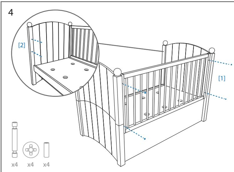
[1] De la misma manera que hemos hecho anteriormente con las bancadas, atornillar la barandilla fija a la estructura a través de las excéntricas.
