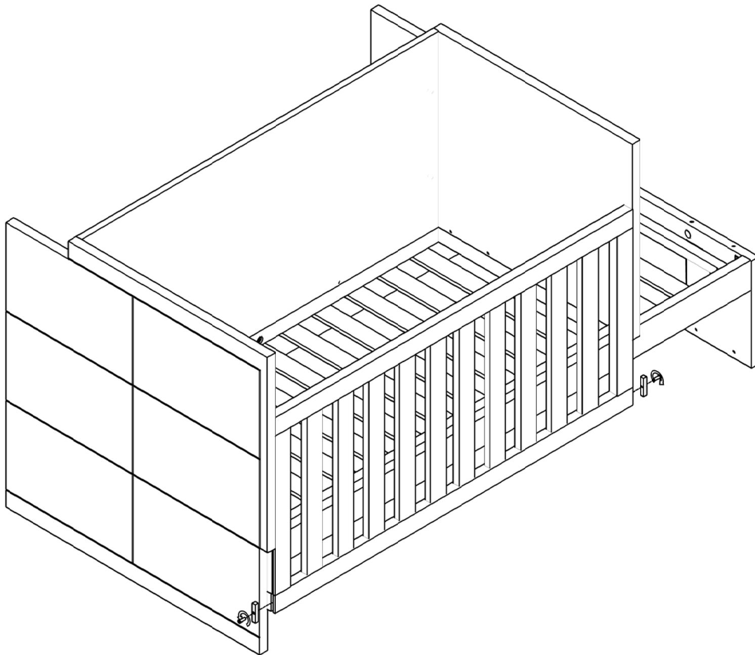
Con la barandilla PIEZA 14 totalmente bajada, desatornillar la PIEZA 15
