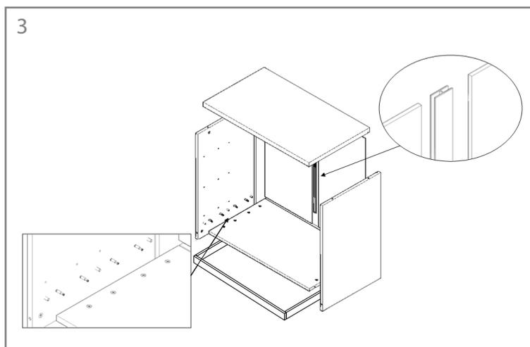
Unir y atornillar los laterales, base, sobre, zocalo y traseras mediante excéntricas, clavias y la guía de plástico.
