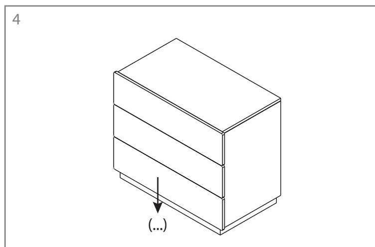
Colocar los cajones en las guías. Tener en cuenta que el cajón marcado (...) siempre deberá ir en la parte inferior.
