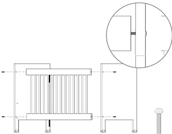
Unir los cabezales A y B con el lateral D utilizando el tirafondo F sin terminar de apretar.
