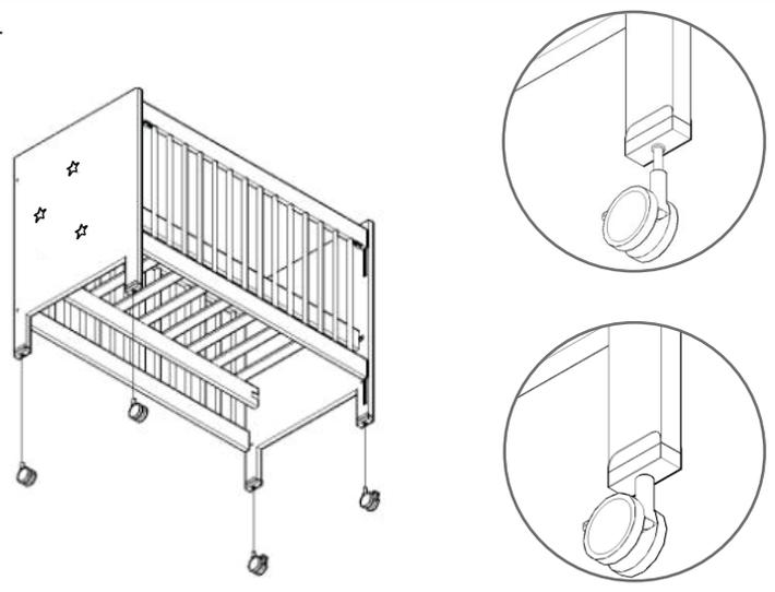
Si desea que su cuna incorpore ruedas. Introducir a presión las ruedas H en el lado del lateral móvil y las ruedas I al del lateral fijo.
