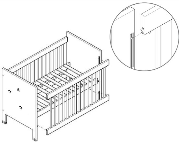
Introducir el lateral E en las guías de los cabezales A y B mediante la unión del saliente fijo con la guía tanto arriba como abajo. Terminar de asegurar todas las piezas.
