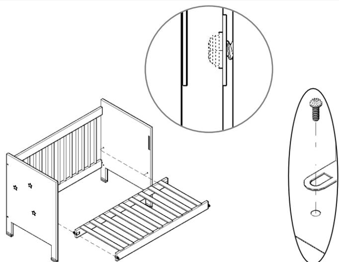
Con el tirafondo G, juntar los cabezales A y B en el somier sin terminar de apretar. Finalizar de asegurar el lateral D.
