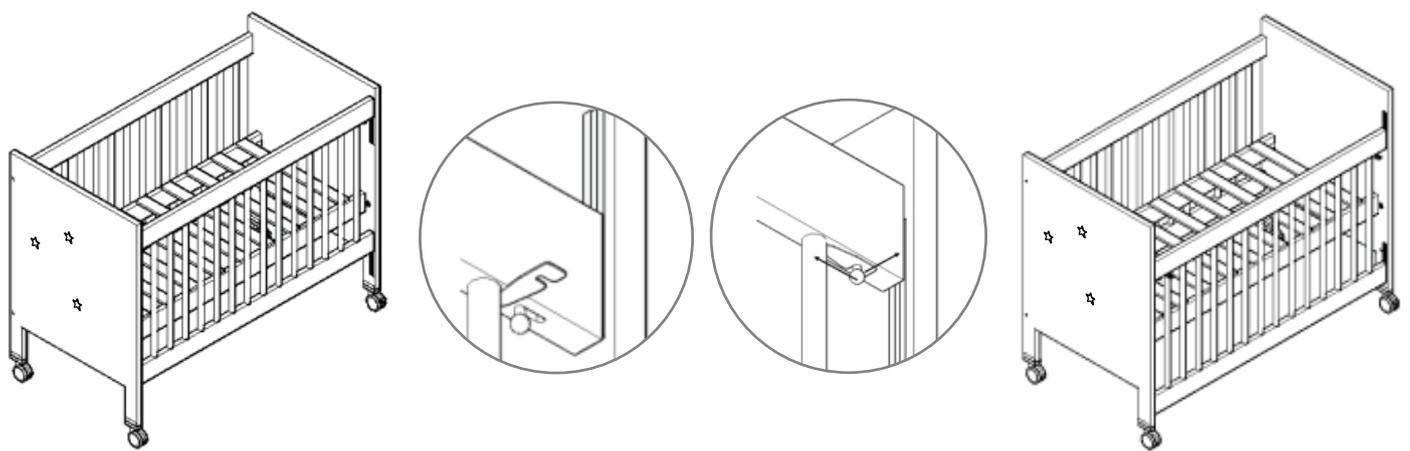
Abrir la pestaña y tirar de la parte móvil del lateral hacia dentro para bajarlo. Volver a tirar de la parte móvil para subirlo. Siempre poner el seguro en la posición alta de la guía.
